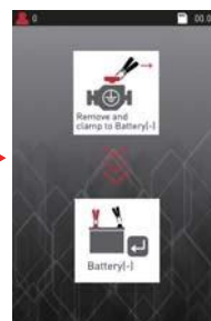
Questa schermata indica che la pinza negativa deve essere fissata sul terminale negativo della batteria
