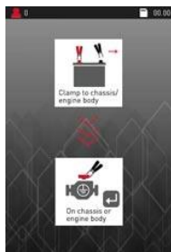
Questa schermata indica che la pinza negativa deve essere fissata al telaio del veicolo
