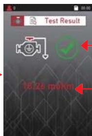
I risultati del test indicano che la connessione a terra è buona
